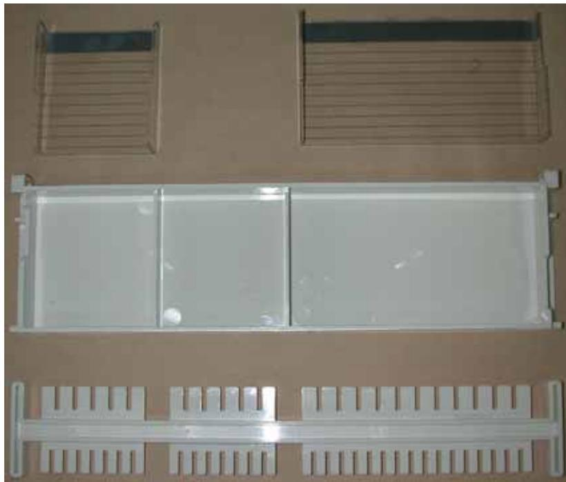
圖 8-7：製膠用品（由上至下分別為 trap、製膠槽、Comb
