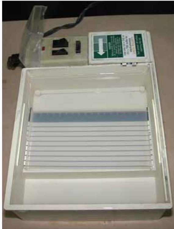
圖 8-6：水平電泳槽
