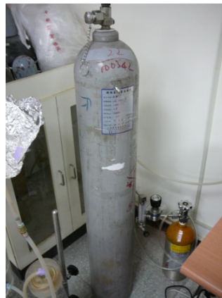
圖 8-6 氨氣提供設備
