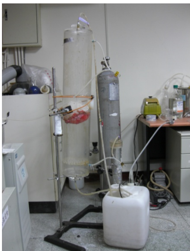
圖 8-1 生物反應器(生物滴濾塔)
